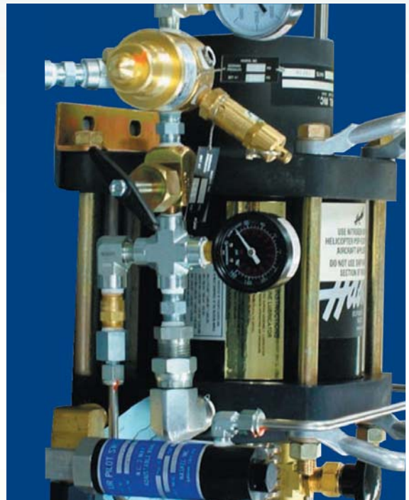
エア駆動ガスブースターの構造
